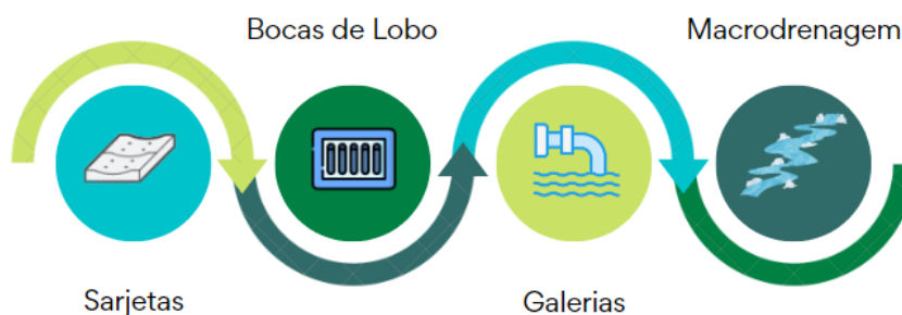
Figura 96 - Esquemática de um Modelo de Drenagem Urbana Municipal.
